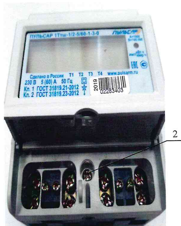
а) Счётчик в корпусе с установкой на дин-рейку
